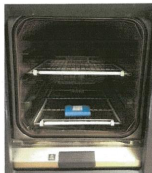
空のチャンバーでドレインの直上に設置
